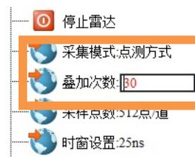
(4) 如右图所示，选择叠加次数，使用确定键打开叠加次数，使用上、下键来增加和减小叠加次数的数值，用户按照探测需要设置叠加次数（一般选择 32-64 次），然后按确定键确定。
