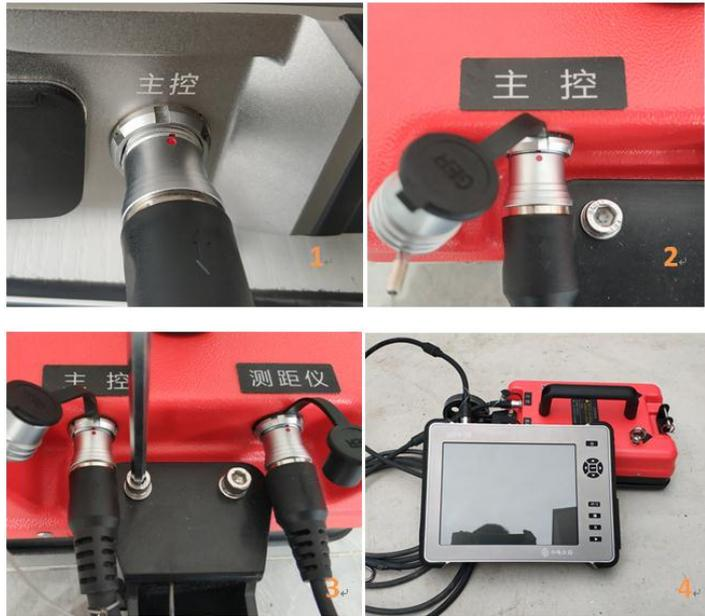
图 7 GER-10 硬件系统连接图
